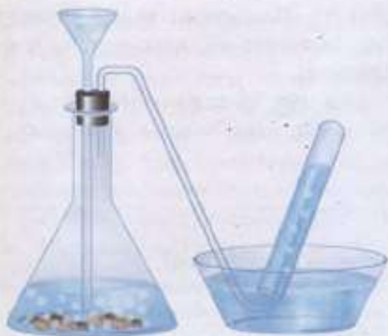
Рис. 64. Получение углекислого газа
