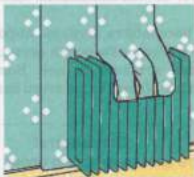
Рис. 28. Оклеивание обоев за радиатором отопления
