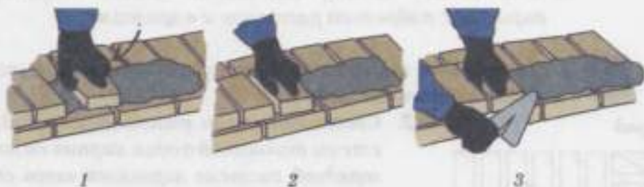
Рис. 76. Кладка способом вприсык с подрезкой раствора тычкового ряда:
