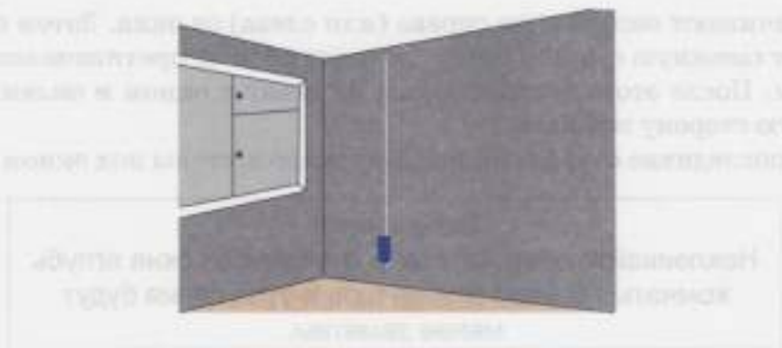
Рис. 21. Провешивание стены отвесом
