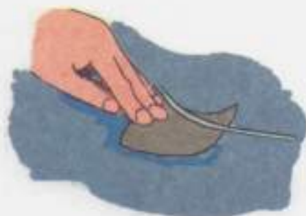
Рис. 48. Обрезка излишков сварочного шнура
