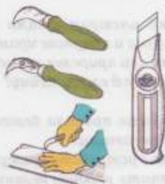
Рис. 33. Ножи для раскроя и прирезок кромок линолеума
