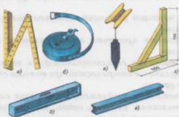
Рис. 61. Контрольно-измерительные инструменты: а – складной метр, б – рулетка, в – отвес, г – угольник, д – строительный уровень, е – правило
