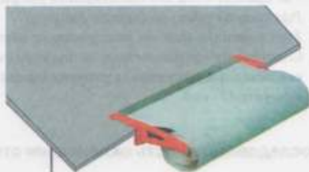
Рис. 19. Раскройное устройство, закреплённое на столе
