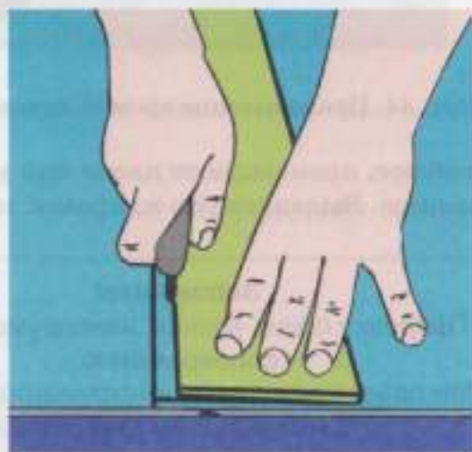
Рис. 43. Прирезка кромок линолеума
