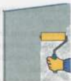
Рис. 15. Грунтование поверхности валиком
