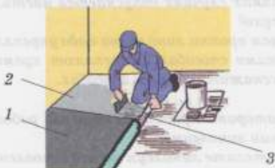
Рис. 39. Разравнивание мастики на основание:
