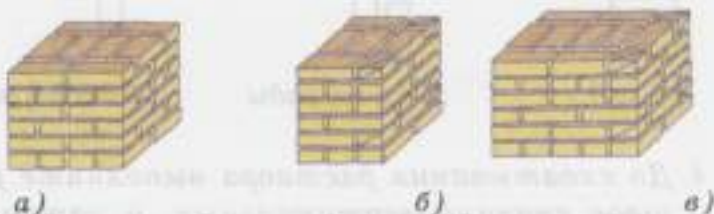
Рис. 80. Кладка столбов по трёхрядной системе перевязки швов сечением:
