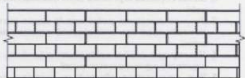
Рис. 65. Однорядная (цепная) система перевязки швов
